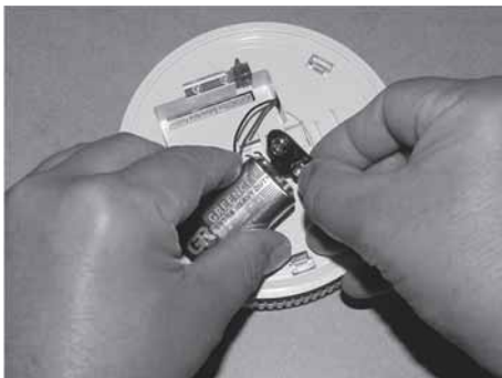
Fig. 229: Remplacer la pile
