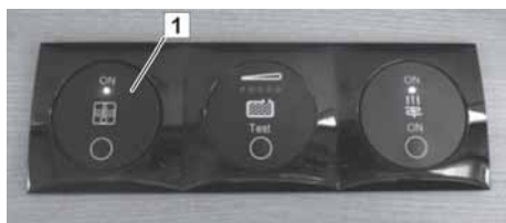
Fig. 100 : Boutons Marche/Arrêt pour la production d'eau chaude
