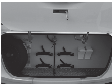
Fig. 115 : Caisson pour les bouteilles de gaz
