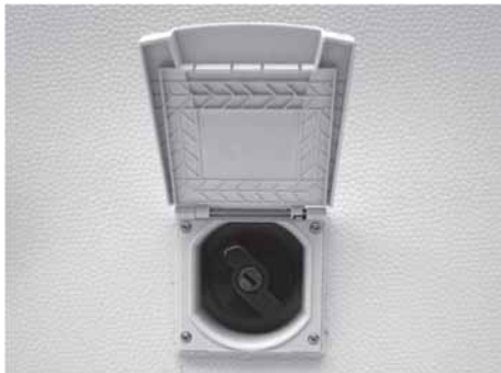
Fig. 92: Manchon de remplissage d'eau fraîche
