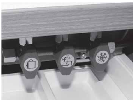
Fig. 78: Vannes d'arrêt rapides
