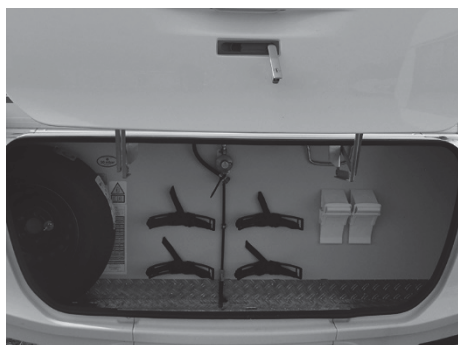
Fig. 113 : Caisson pour les bouteilles de gaz
