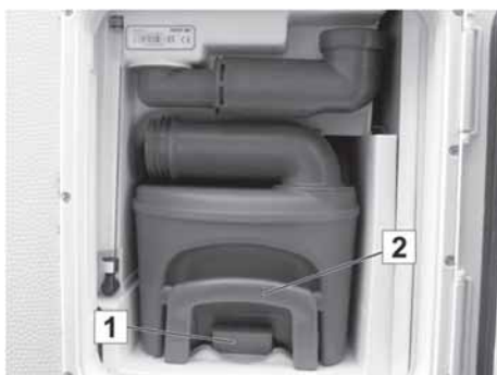
Fig. 200 : Cassette WC dans le puisard d'élimination
