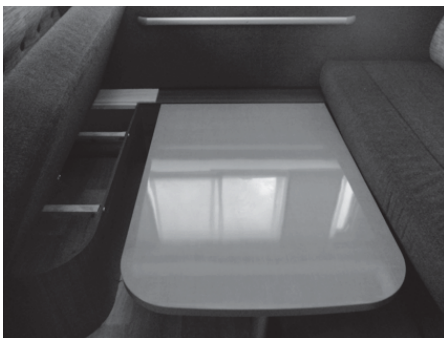
Fig. 190 : Table accrochée dans le rail inférieur.
