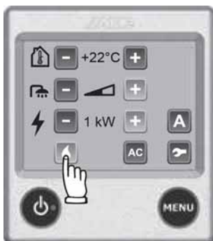
Fig. 169 : Chauffage au gaz
