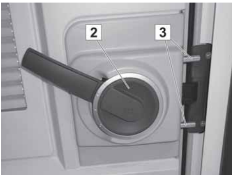
Fig. 15: Porte fermée et sécurisée
