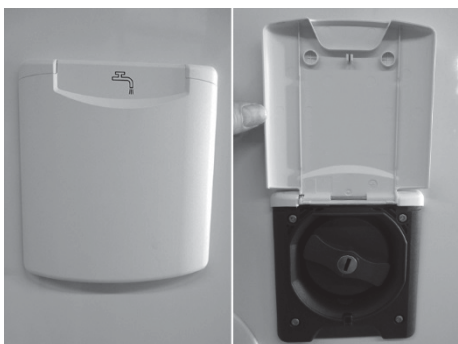
Fig. 21 : Manchon de remplissage d'eau fraîche
