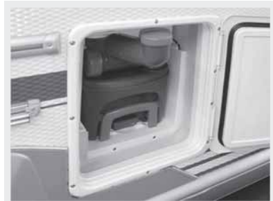
Abb. 46: Fäkalientank mit Spülwasser-Einfüllstutzen
