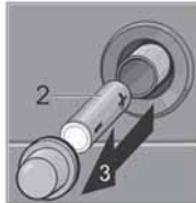
Abb. 209: Batteriewechsel bei Batterie-zünder (nur wenn vorhanden)
