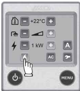
Abb. 166: Heizen mit Gas
