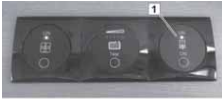
Abb. 83: Ein-/Aus-Schalter der Fußbodentemperierung
