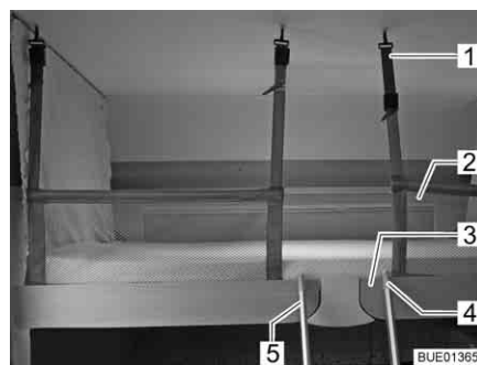
Fig. 80 Lit escamotable avec filet de sécurité tendu
