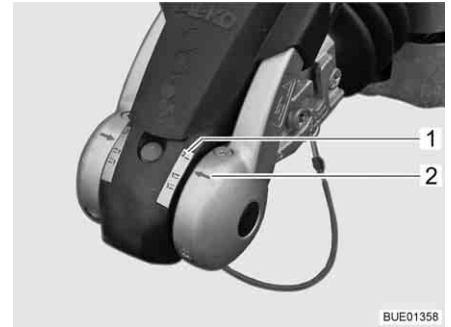
Fig. 7 Contrôle "AKS terminé"
