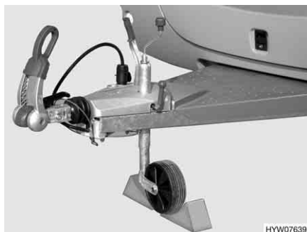
Fig. 229 Bloquer la roue d'appui
