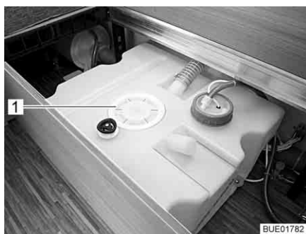
Fig. 205 Ouverture de nettoyage du réservoir d'eau
