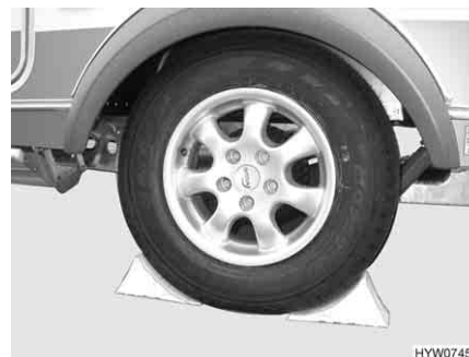
Fig. 230 Bloquer le véhicule
