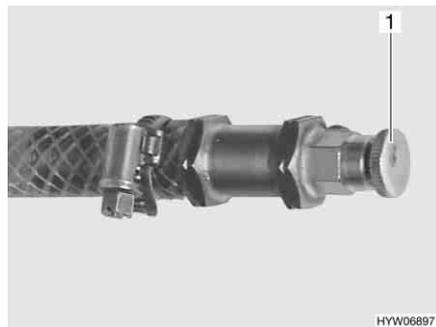
Fig. 214 Valvola di sfiato del riscaldamento ad acqua calda
