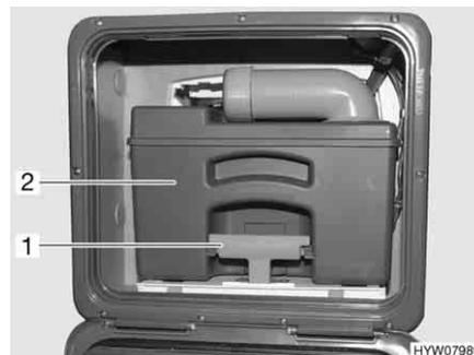
Fig. 196 Serbatoio fecale (esempio)
