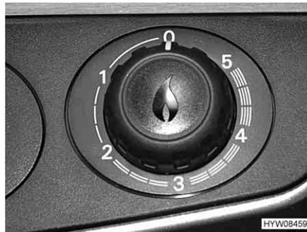
Fig. 144 Pomello girevole del riscaldamento ad aria calda
