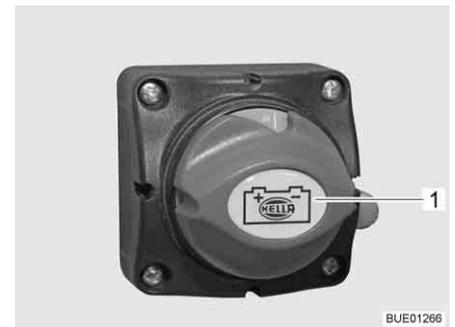
Fig. 115 Interruttore principale batteria, posizione "ON"
