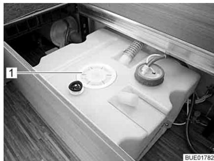
Fig. 205 Apertura per la pulizia sul serbatoio dell'acqua
