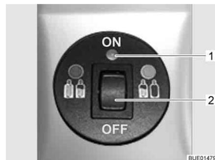
Fig. 112 Centralina di controllo con visualizzatore a distanza
