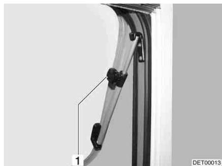
Fig. 55 Finestra apribile con deflettore a rotazione
