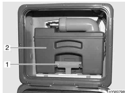
Fig. 204 Serbatoio fecale (esempio)
