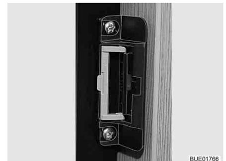
Fig. 187 Dispositivo di chiusura in posizione di ricircolo d'aria
