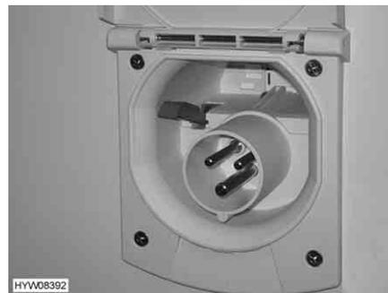
Fig. 121 Collegamento a 230 V sul veicolo
