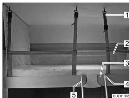
Fig. 80 Letto basculante con rete protettiva montata
