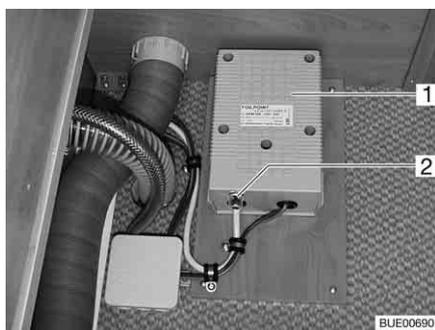
Fig. 152 Trasformatore per riscaldamento elettrico del pavimento
