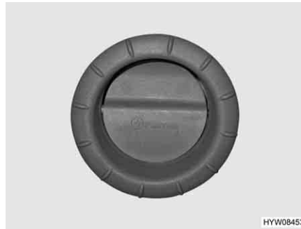
Fig. 134 Boquilla de salida de aire de la calefacción de aire caliente
