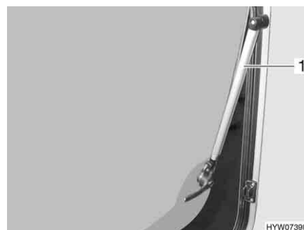
Fig. 56 Ventana abatible con soporte automático
