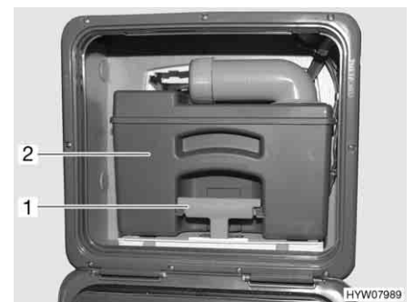
Fig. 196 Depósito de aguas fecales (ejemplo)
