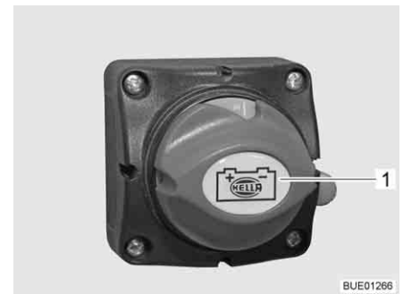
Fig. 115 Interruptor principal de la batería, posición "ON"
