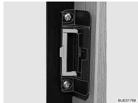
Fig. 187 Dispositivo de cierre en posición de ventilación
