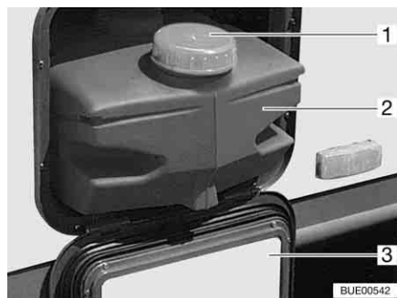
Fig. 188 Depósito de agua 22 l
