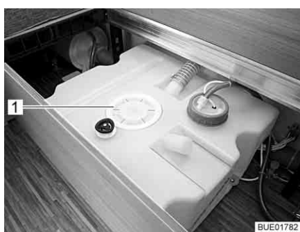
Fig. 205 Orificio de limpieza del depósito de agua
