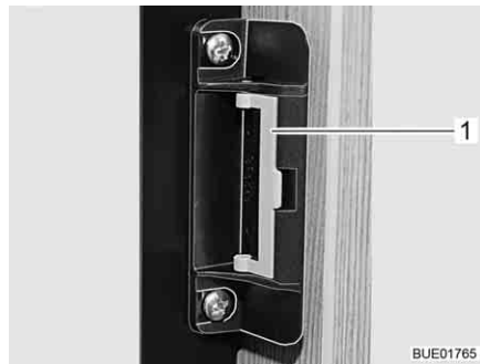
Fig. 186 Dispositivo de cierre en posición normal
