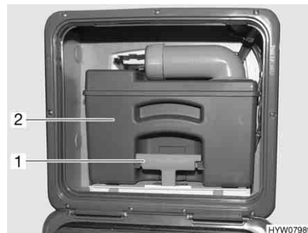
Fig. 204 Depósito de aguas fecales (ejemplo)
