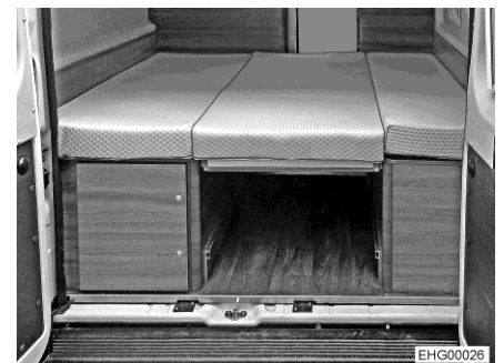
Fig. 41 Lit arrière transversal après la transformation (variante à 3 coussins longitudinaux)
