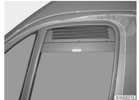
Fig. 54 Grille d'aération forcée (fenêtre latérale fermée)
