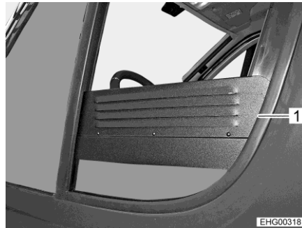
Fig. 53 Grille d'aération forcée (fenêtre latérale ouverte)
