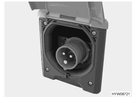
Fig. 72 Raccordement 230 V sur le véhicule (prise de courant CEE)
