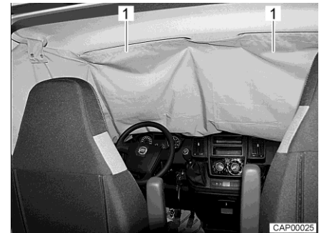
Fig. 17 Dispositif occultant de la cabine de conduite sur le pare-brise
