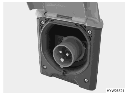
Fig. 33 Raccordement 230 V sur le véhicule (prise de courant CEE)
