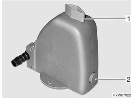
Fig. 68 Valve de sécurité et de vidange
