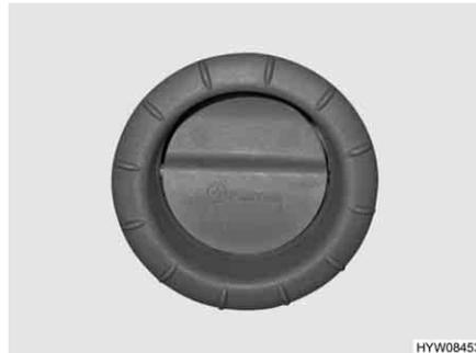
Fig. 53 Buse de sortie d'air du chauffage à air chaud
