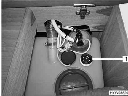
Fig. 72 Poignée tournante vidange d'eau
