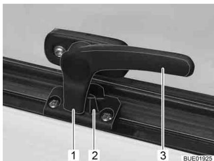
Fig. 11 Levier de verrouillage en position "Fermé"
