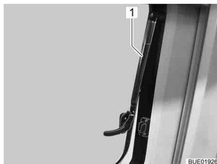
Fig. 12 Fenêtre projetante avec bras automatiques, ouverte
