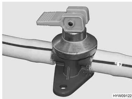
Fig. 69 Robinet de vidange avec levier à bascule
