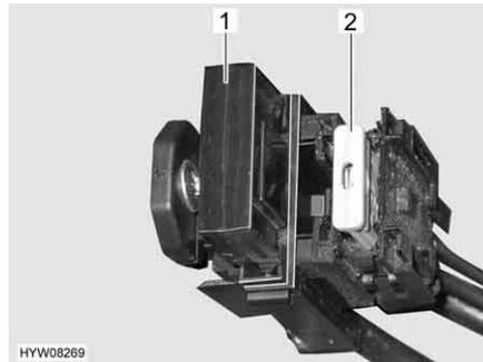
Fig. 45 Fusibles de la batterie de démarrage
