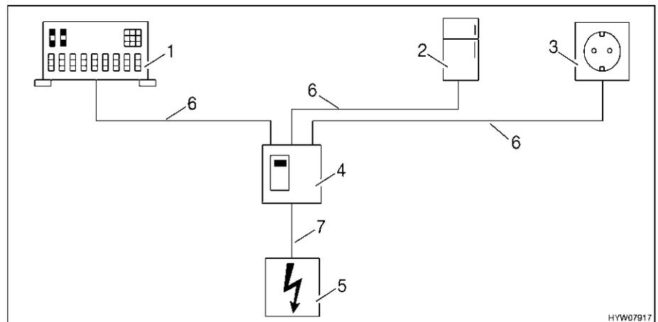
Fig. 50 Schéma du plan des circuits de 230 V
