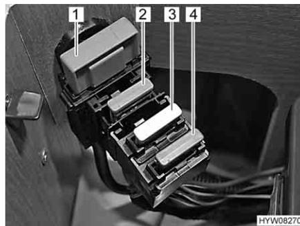
Fig. 46 Fusibles de la batterie de cellule
