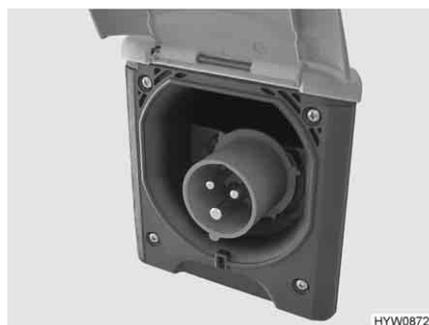
Fig. 44 Raccordement 230 V sur le véhicule
