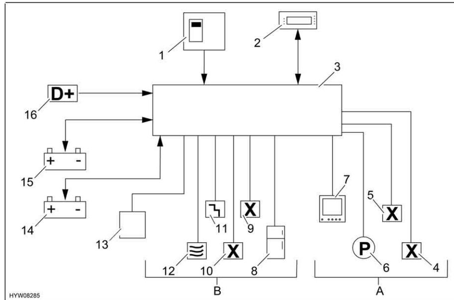
Fig. 51 Schéma du plan des circuits de 12 V
