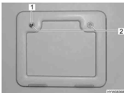
Fig. 81 Portillon pour le réservoir pour matières fécales
