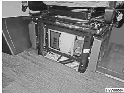
Fig. 49 Emplacement du coffret de fusibles 230 V
