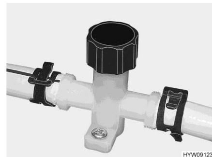
Fig. 147 Robinet de vidange avec bouton tournant
