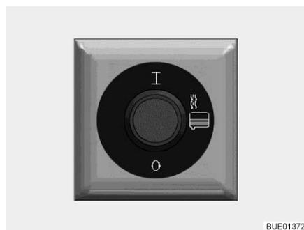
Fig. 150 Interrupteur pour le chauffage des eaux usées
