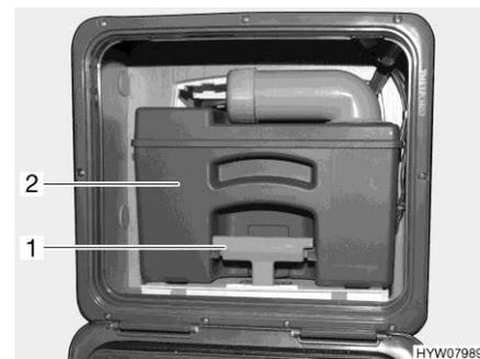
Fig. 153 Réservoir pour matières fécales (exemple)
