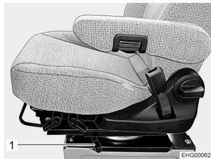
Fig. 18 Levier de déverrouillage
