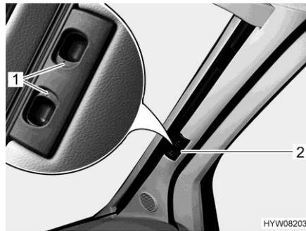
Fig. 24 Dispositif occultant plissé pour le pare-brise
