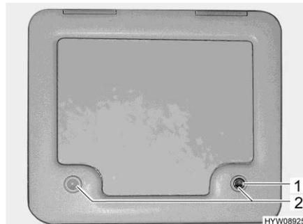
Fig. 160 Portillon pour le réservoir pour matières fécales
