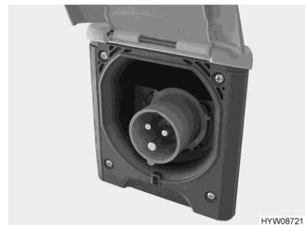
Fig. 101 Raccordement 230 V sur le véhicule (prise de courant CEE)
