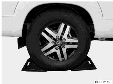
Fig. 172 Bloquer le véhicule
