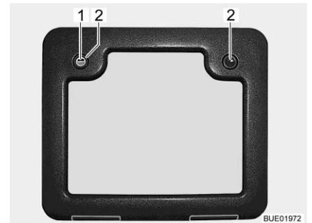
Fig. 40 Verrou de pression du portillon de service (alternative)
