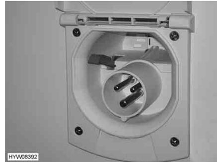
Fig. 121 Raccordement 230 V sur le véhicule
