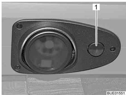
Fig. 57 Lampe DEL encastrée, interrupteur d'éclairage directement sur la lampe
