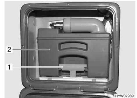
Fig. 174 Réservoir pour matières fécales (exemple)
