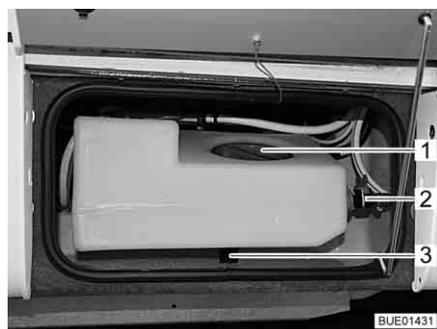
Fig. 162 Réservoir d'eau supplémentaire
