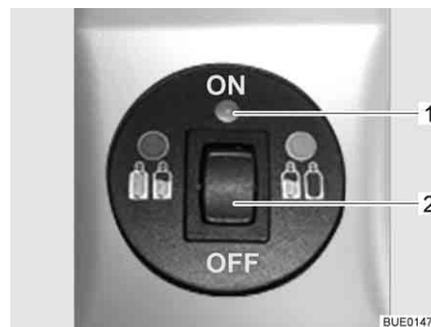
Fig. 112 Unité de commande avec affichage à distance
