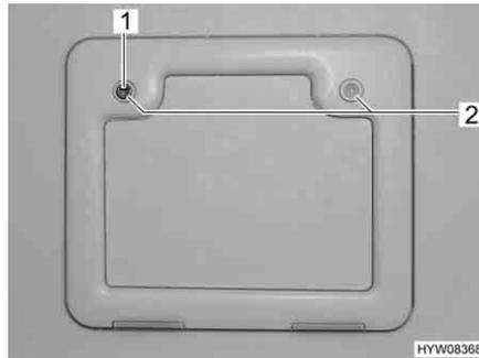
Fig. 173 Portillon pour le réservoir pour matières fécales
