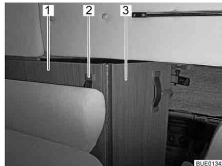
Fig. 51 Séparation pour la cabine de conduite
