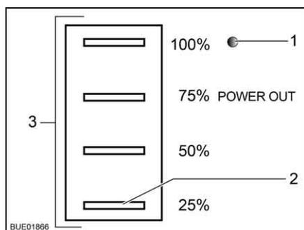
Fig. 119 Indicateur d'état régulateur de panneau solaire
