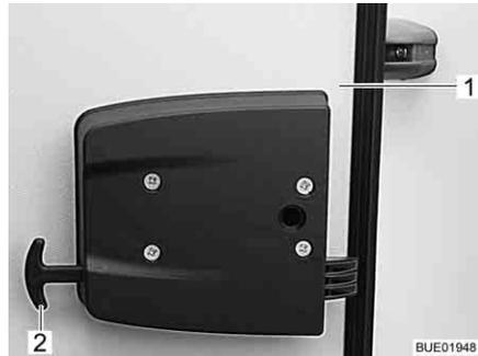
Fig. 39 Dispositif de déverrouillage de secours du portillon de garage
