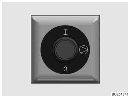
Fig. 141 Commutateur de commande du circulateur supplémentaire
