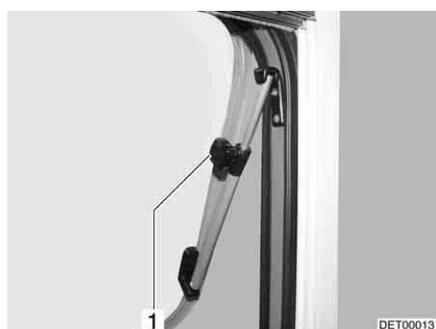
Fig. 68 Fenêtre projetante avec bras pivotant
