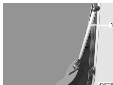
Fig. 69 Fenêtre projetante avec bras automatique
