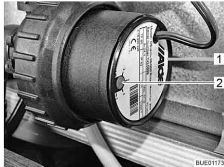
Fig. 137 Réduction de la vitesse de rotation
