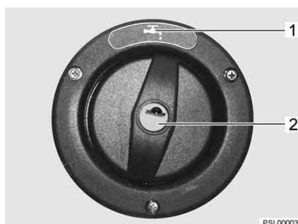
Fig. 43 Couvercle de fermeture pour bec de remplissage d'eau potable
