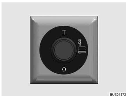
Fig. 171 Interrupteur pour le chauffage des eaux usées
