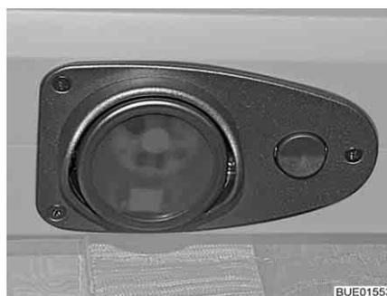
Fig. 190 Lampe DEL avec interrupteur
