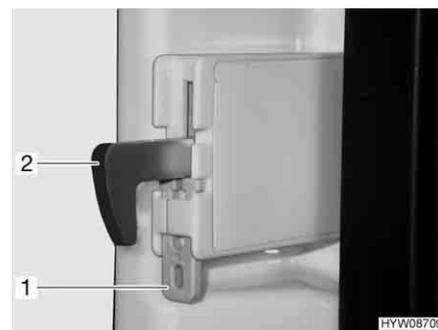
Fig. 159 Fixation (crochet de verrouillage)
