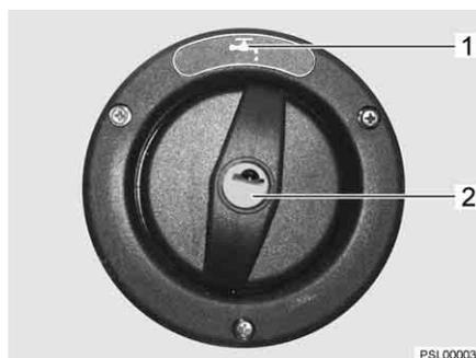
Fig. 164 Couvercle de fermeture pour bec de remplissage d'eau potable
