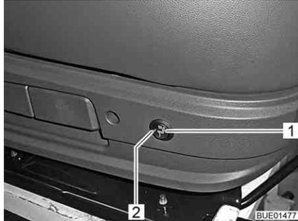
Fig. 18 Interrupteur du chauffage de siège
