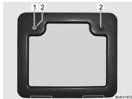
Fig. 41 Verrou de pression du portillon de service (alternative)
