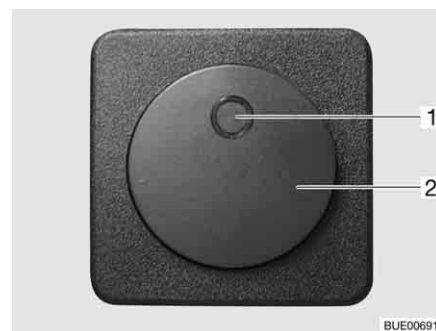
Billede 210 Kontakt for elektrisk gulvopvarmning
