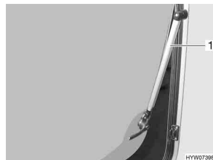
Billede 81 Ventilationsrude med automatiske udskydere
