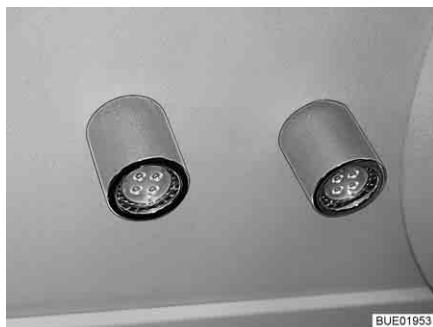
Billede 68 Loftslampe, adskilt fra kontakten (eksempel)
