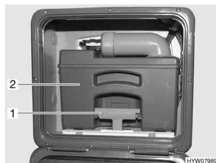
Billede 257 Toilettank (eksempel)
