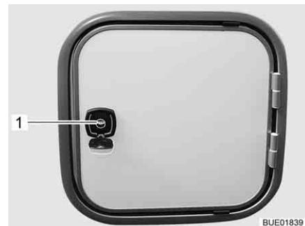
Fig. 255 Sportello per il serbatoio fecale (alternativa)
