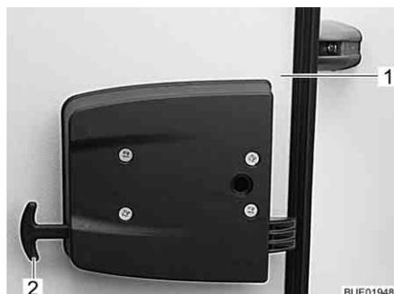
Fig. 72 Sbloccaggio di emergenza dello sportello del garage
