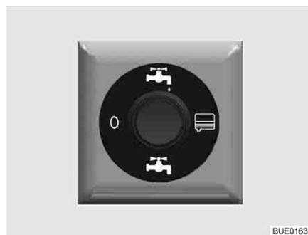
Fig. 241 Interruttore di comando per rubinetto di scarico ad azionamento elettrico (parzialmente accessorio opzionale)
