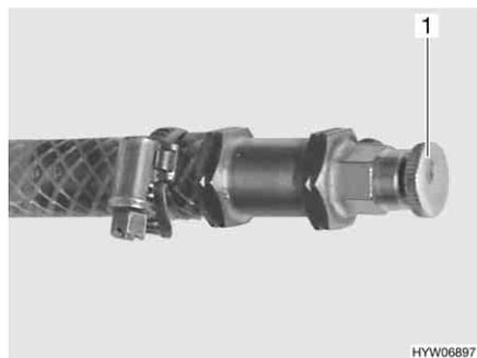
Fig. 262 Valvola di sfiato del riscaldamento ad acqua calda
