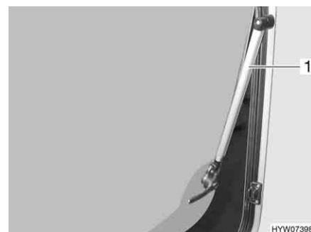
Fig. 110 Finestra apribile con deflettore automatico
