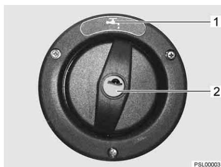
Fig. 225 Coperchio per bocchettone di riempimento dell'acqua potabile
