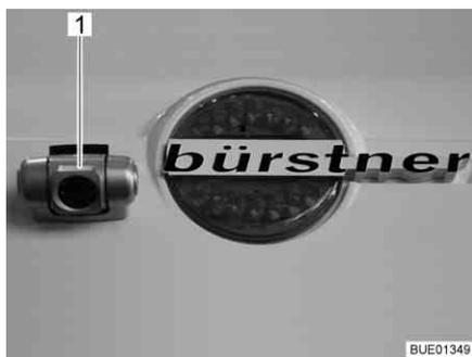
Fig. 22 Telecamera retromarcia con luce a infrarossi
