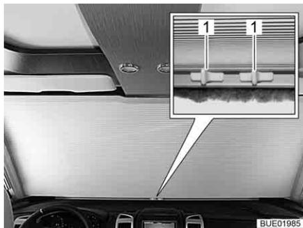
Fig. 120 Oscurante del parabrezza manuale, chiuso
