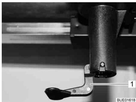
Fig. 135 Sbloccaggio del piano del tavolo
