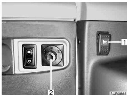
Fig. 36 Interruttore regolazione degli specchietti esterni e riscaldamento degli specchietti esterni (Viseo)
