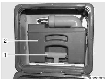
Fig. 256 Serbatoio fecale (esempio)
