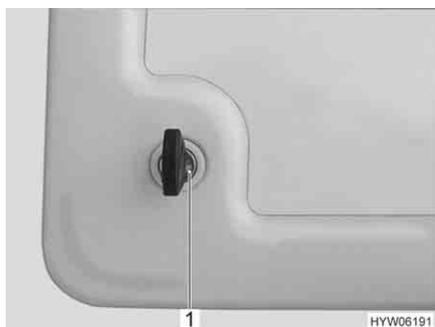
Fig. 74 Serratura a pressione sportello di servizio
