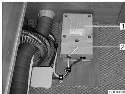
Fig. 202 Trasformatore per riscaldamento elettrico del pavimento
