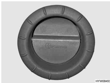
Fig. 184 Bocchetta di uscita dell'aria del riscaldamento ad aria calda
