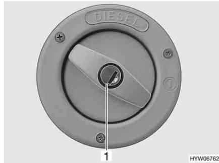
Fig. 47 Coperchio per bocchettone di riempimento per il rifornimento di carburante
