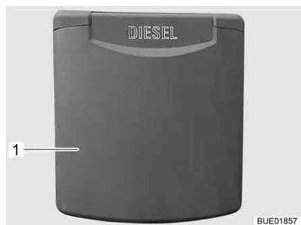
Fig. 48 Sportello esterno del bocchettone di riempimento per il rifornimento di carburante
