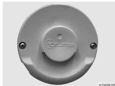
Fig. 200 Camino da parete del riscaldamento ad aria calda
