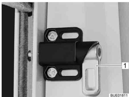
Fig. 121 Chiusura di sicurezza oscurante del parabrezza
