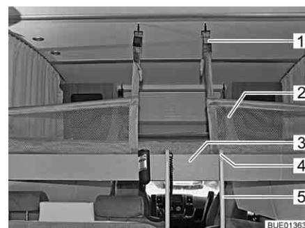
Fig. 144 Letto basculante con rete protettiva montata
