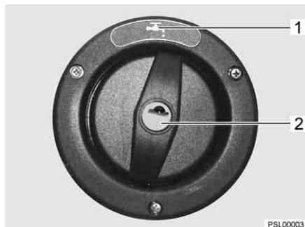
Fig. 77 Coperchio per bocchettone di riempimento dell'acqua potabile (Viseo)
