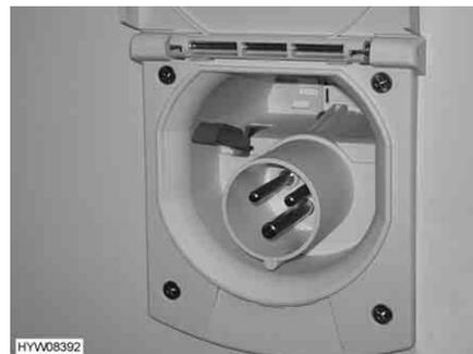
Fig. 168 Collegamento a 230 V sul veicolo
