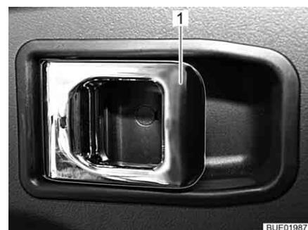
Fig. 66 Serratura della porta conducente, lato interno (Elegance)
