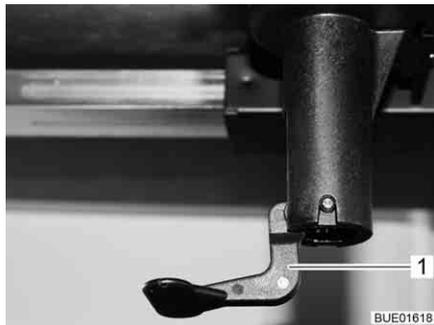
Fig. 135 Unlocking of the table top
