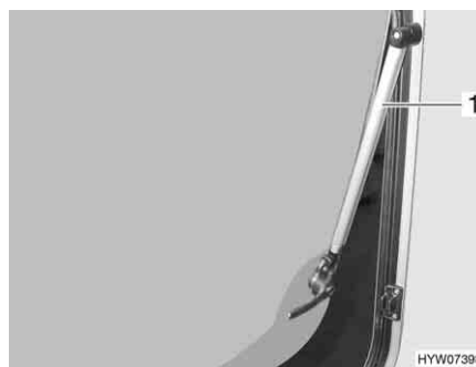
Kuva 110 Avattavat ikkunat, joissa on automaattipidikkeet
