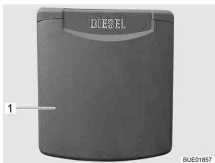
Kuva 48 Polttoaineen täyttöaukon ulkoluukku
