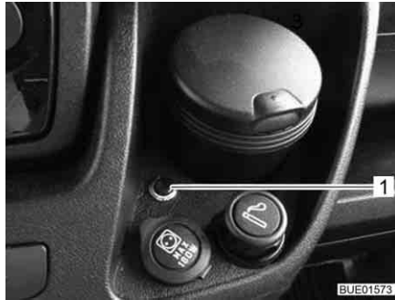
Billede 48 Trykknop til aktivering af fjernstyring
