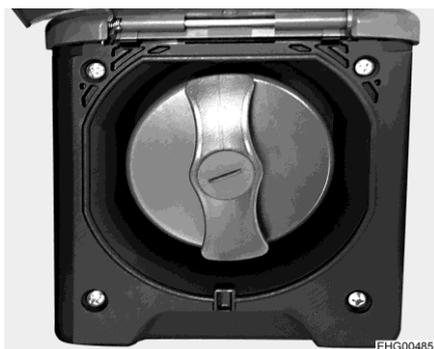
Fig. 58 Coperchio per bocchettone di riempimento dell'acqua potabile
