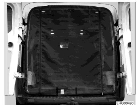
Fig. 11 Protezione contro gli insetti, in coda
