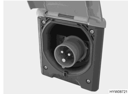
Fig. 43 Collegamento a 230 V al veicolo (presa CEE)
