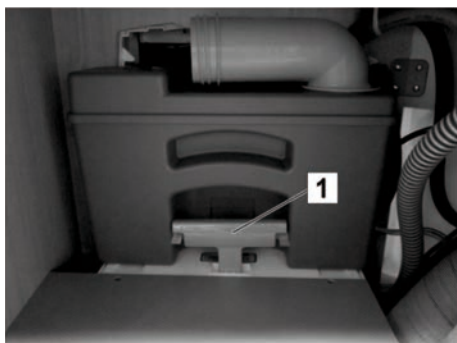
Fig. 145 : Casette WC dans le puisard d'élimination
