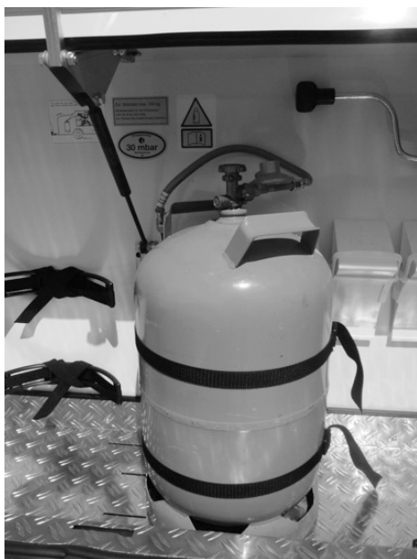
Fig. 76 : Caisson à gaz ouvert
