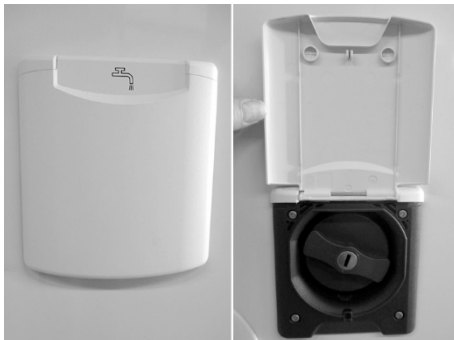
Fig. 32 : Manchon de remplissage d'eau fraîche
