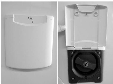
Fig. 96 : manchon de remplissage d'eau fraîche
