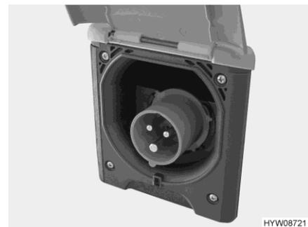
Fig. 48 Raccordement 230 V sur le véhicule (prise de courant CEE)
