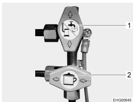
Fig. 44 Robinets d'arrêt de gaz
