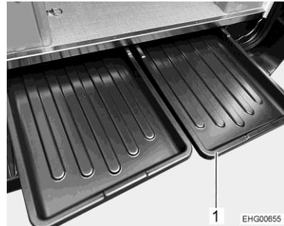
Fig. 27 Plateaux coulissants double plancher (équipement spécial)
