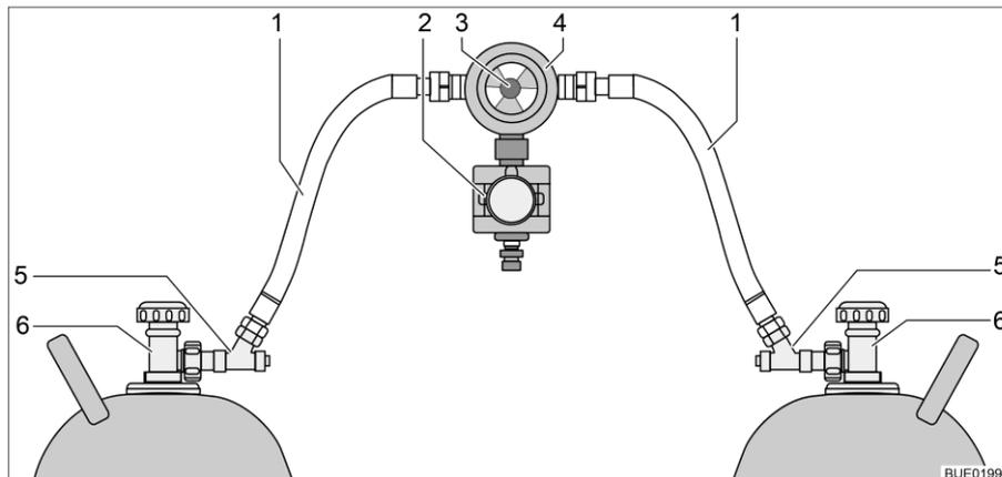
Fig. 4 Régulateur de gaz avec CPU et sécurité de rupture de tuyau
