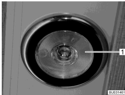
Fig. 31 Lampe dans la zone arrière
