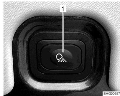
Fig. 33 Interrupteur pour la lampe
