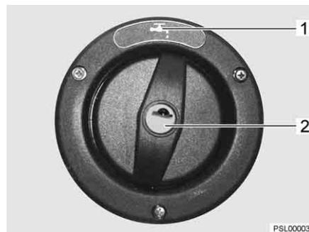
Fig. 32 Tapa de cierre para el tubo de llenado de agua potable (alternativa)
