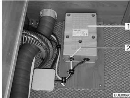
Fig. 132 Transformador para calentamiento eléctrico del piso
