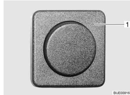
Fig. 42 Iluminación del habitáculo, interruptor de luz separado de la lámpara
