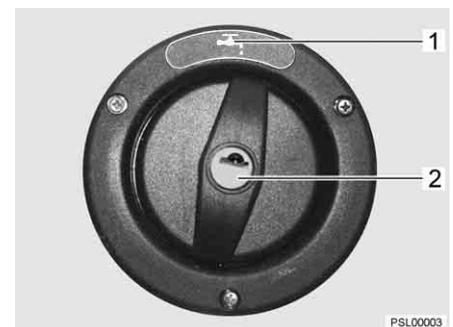
Fig. 165 Tubo de llenado de agua potable (alternativa)
