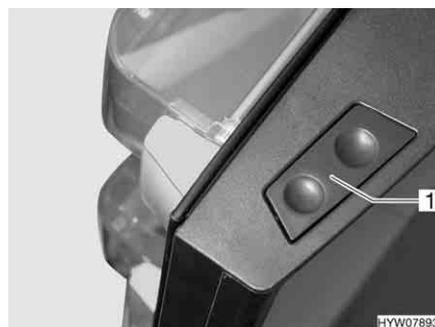
Fig. 158 Botón de desbloqueo de la puerta del frigorífico (Dometic de la serie 8)
