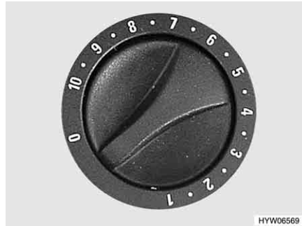
Afb. 124 Draairegelaar aan de verwarming
