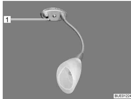
Afb. 39 Toiletruimteverlichting, lichtschakelaar direct bij de lamp
