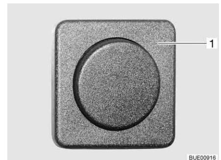
Fig. 40 Illuminazione del vano WC, interruttori luci staccati dalla lampada
