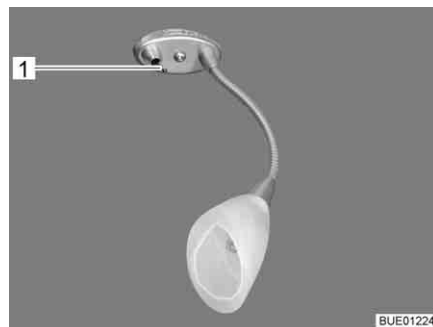
Fig. 39 Illuminazione del vano WC, interruttori luci in corrispondenza della lampada
