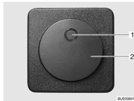
Fig. 133 Interruttore per riscaldamento elettrico del pavimento
