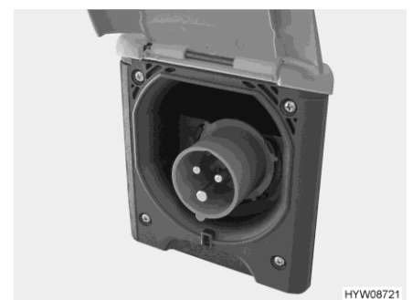
Fig. 98 Collegamento a 230 V al veicolo (presa CEE)
