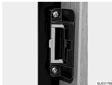
Fig. 117 Dispositivo di chiusura in posizione di ricircolo d'aria
