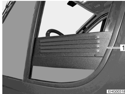
Fig. 78 Griglia di aerazione forzata (finestrino abbassato)
