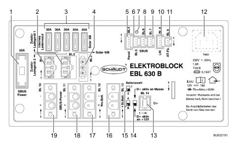
Fig. 108 Transformer/rectifier (EBL 630)
