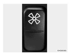
Fig. 130 Auxiliary fan rocker switch
