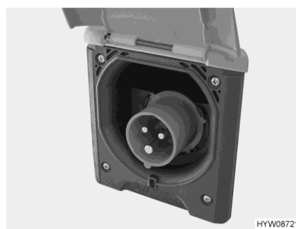
Bild 111 230-V-Anschluss am Fahrzeug (CEE-Steckdose)
