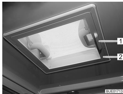
Bild 91 Taklucka med snäpplås
