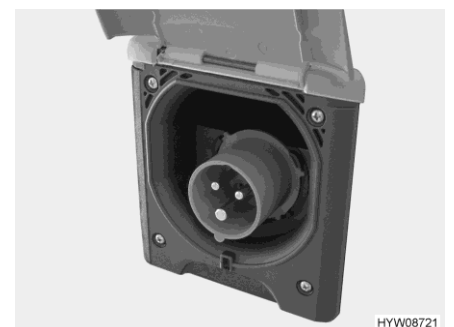
Bild 111 230 V-anslutning på fordonet (CEE-uttag)
