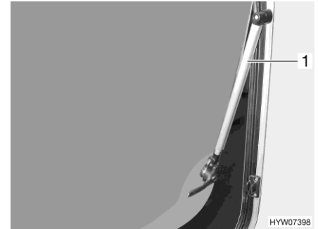
Billede 80 Ventilationsrude med automatiske udskydere
