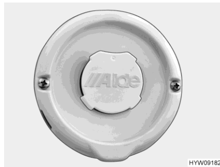
Billede 138 Vægskorsten (varmtvands-varmeovn)
