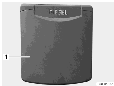
Kuva 40 Polttoaineen täyttöaukon ulkoluukku
