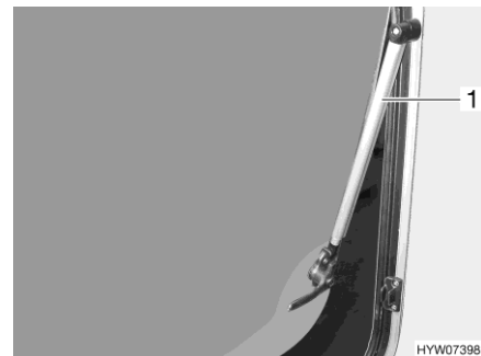
Kuva 80 Avattava ikkuna, jossa on automaattipidike
