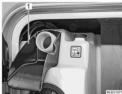
Bild 174 Påfyllningshjälp
