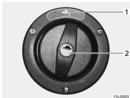
Bild 169 Påfyllningsöppning för dricksvatten i fordonets sidovägg
