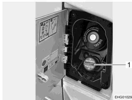
Bild 35 Påfyllningsöppning för AdBlue®
