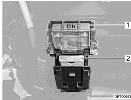
Bild 51 Säkringar vid bodelsbatteriet
