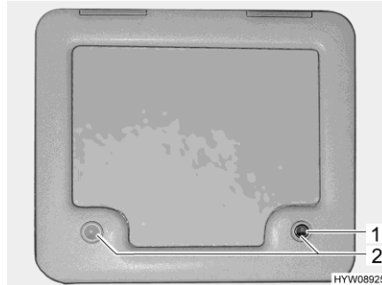
Bild 78 Lucka för latrintanken
