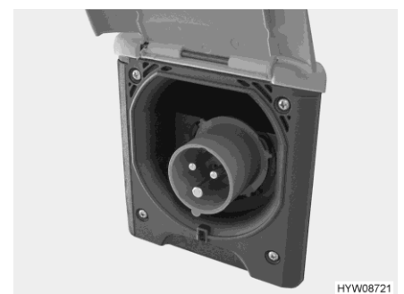
Bild 48 230-V-Anschluss am Fahrzeug (CEE-Steckdose)
