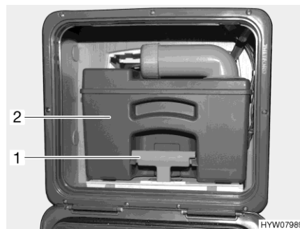
Billede 292 Toilettank (eksempel)
