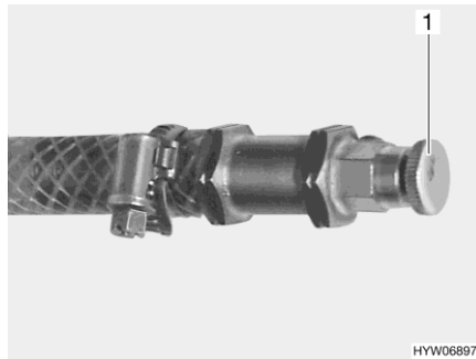
Billede 310 Udluftningsventil varmtvandsvarmeovn
