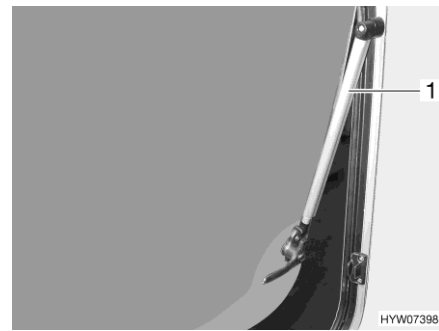
Billede 100 Ventilationsrude med automatiske udskydere
