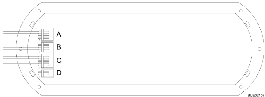
Afb. 120 Aansluitschema, paneel (LT 633)
