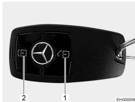
Fig. 32 Mando a distancia del cierre centralizado
