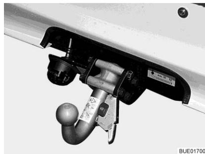
Fig. 4 Acoplamiento de remolque, desmontable
