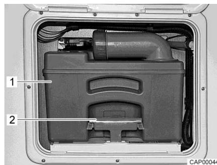
Fig. 161 Depósito de aguas fecales
