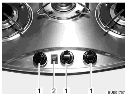
Fig. 128 Elementos de mando para la cocina de gas
