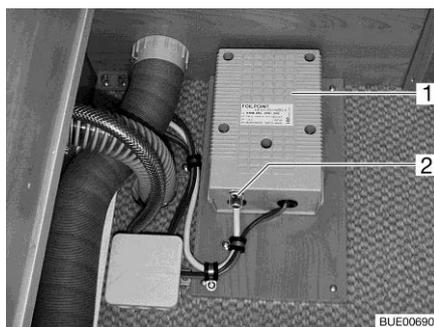
Fig. 120 Transformador para calentamiento eléctrico del piso
