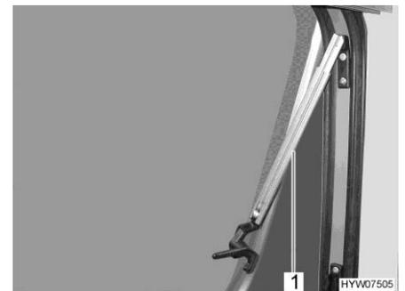
Fig. 55 Ventana abatible con soportes automáticos (abierta)
