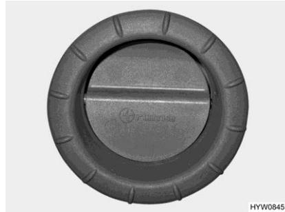
Fig. 114 Boquilla de salida de aire (calefacción de aire caliente)
