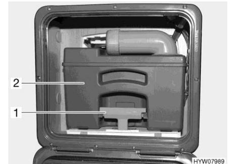
Fig. 153 Depósito de aguas fecales (ejemplo)
