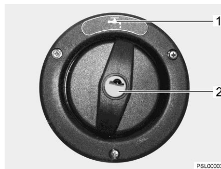
Billede 45 Dæksel til drikkevands-påfyldningsstuds
