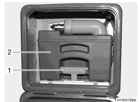
Billede 177 Toilettank (eksempel)
