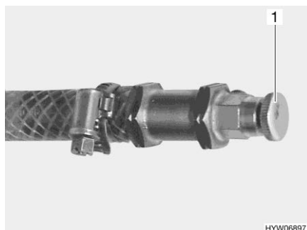
Billede 187 Udluftningsventil varmtvandsvarmeovn
