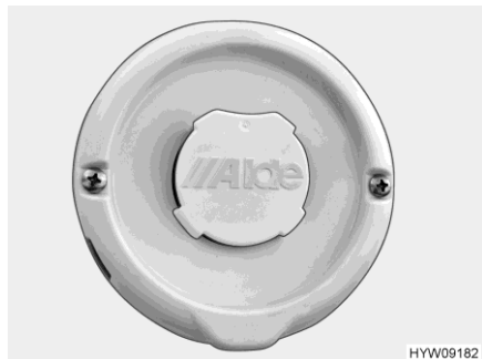
Billede 146 Vægskorsten (varmtvandsvarmeovn)
