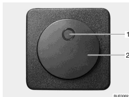
Billede 148 Kontakt for elektrisk gulvopvarmning
