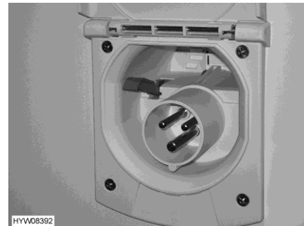
Afb. 123 230-V-aansluiting op het voertuig
