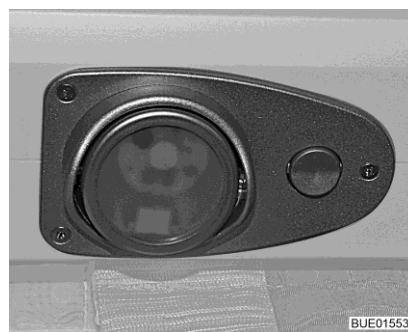
Afb. 193 LED-lamp met schakelaar
