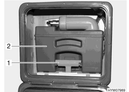
Afb. 211 Fecaliëntank (voorbeeld)
