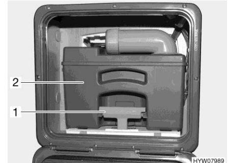
Afb. 203 Fecaliëntank (voorbeeld)
