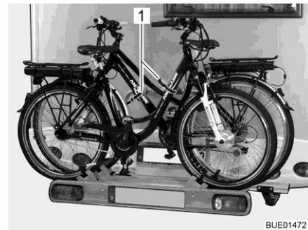
Fig. 5 Disposición de bicicletas eléctricas
