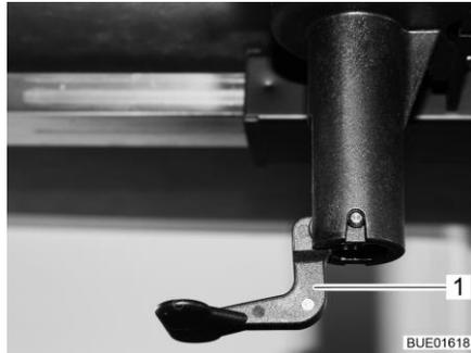
Fig. 117 Desbloqueo del tablero de la mesa
