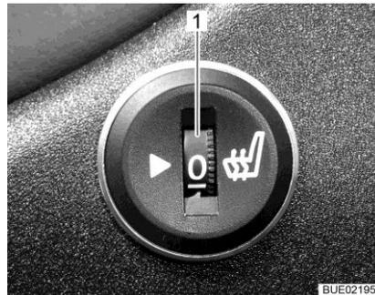
Fig. 29 Rueda de ajuste, calefacción de asiento
