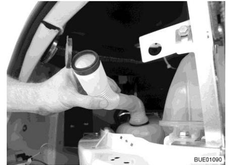
Fig. 43 Tubo de llenado en posición de llenado
