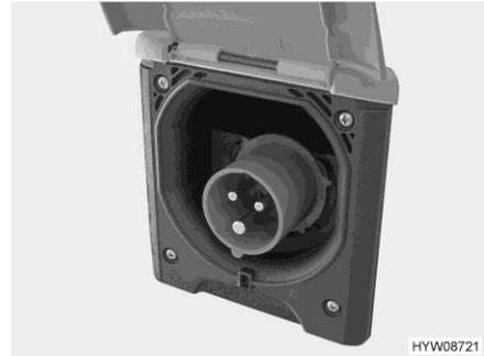
Fig. 143 Conexión de 230 V en el vehículo
