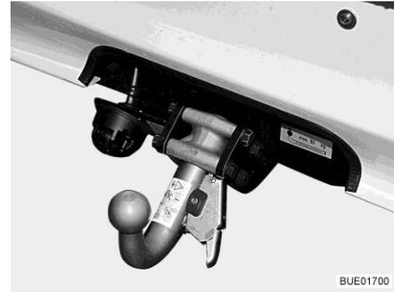
Fig. 8 Acoplamiento de remolque, desmontable
