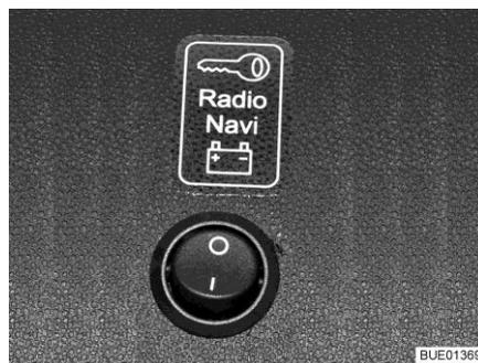
Fig. 138 Conmutador selector de alimentación de corriente
