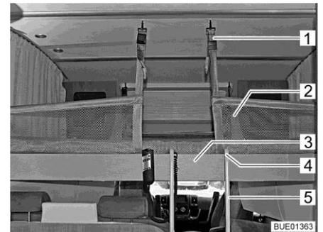
Fig. 123 Cama elevada con red de seguridad tendida
