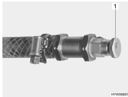
Fig. 215 Válvula de purga de la calefacción de agua caliente
