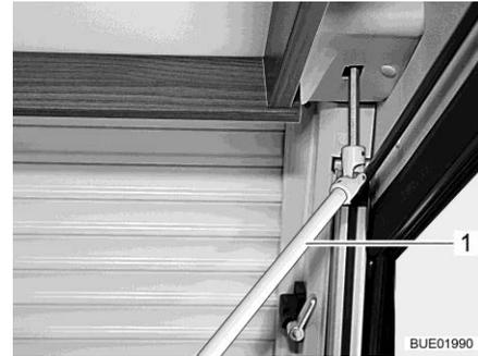
Fig. 107 Manivela para el funcionamiento de emergencia
