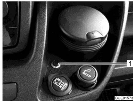
Fig. 51 Pulsador para activar el control remoto
