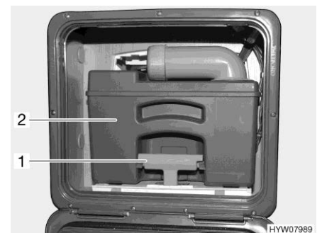
Fig. 203 Serbatoio fecale (esempio)
