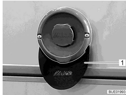
Fig. 13 Convogliatore di condensa del camino
