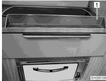
Fig. 176 Lamiera di protezione dal calore (non agganciata)
