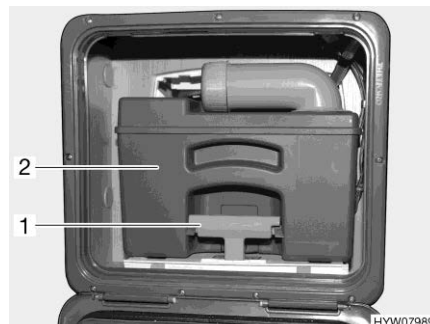
Fig. 211 Serbatoio fecale (esempio)
