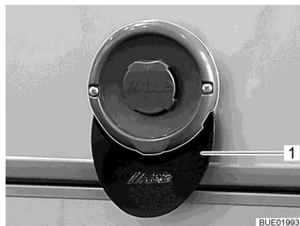
Fig. 167 Convogliatore di condensa del camino
