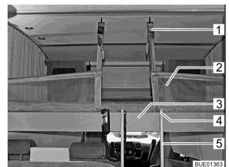
Bild 141 Hubbett mit aufgespanntem Sicherungsnetz
