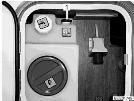
Bild 257 Wassertank (Service-Unit)
