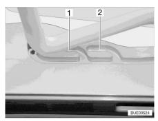
Fig. 66 Guide (ventilation position)
