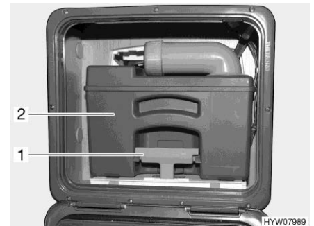
Fig. 153 Serbatoio fecale (esempio)
