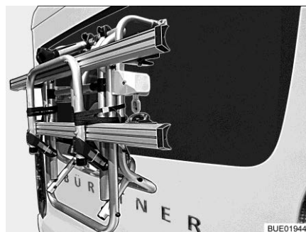
Fig. 2 Portabiciclette, ribaltabile verso l'alto
