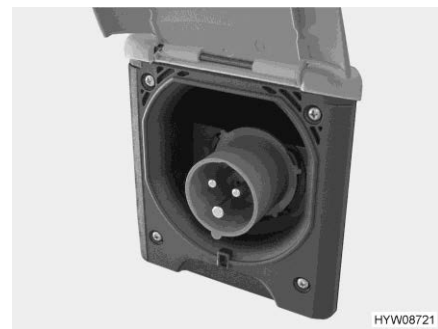
Billede 101 230 V-tilslutning på køretøj (CEE-stikkontakt)
