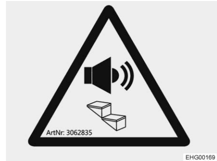
Billede 7 Mærke til Advarselstonen indgangstrin
