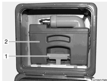
Billede 153 Toilettank (eksempel)
