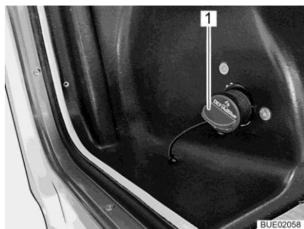
Billede 43 Påfyldningsstuds til AdBlue®
