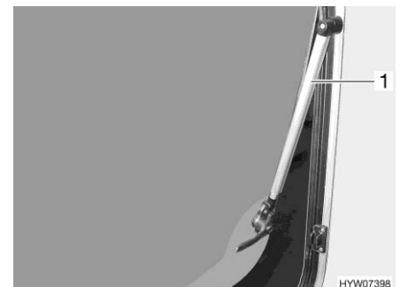
Billede 96 Ventilationsrude med automatiske udskydere
