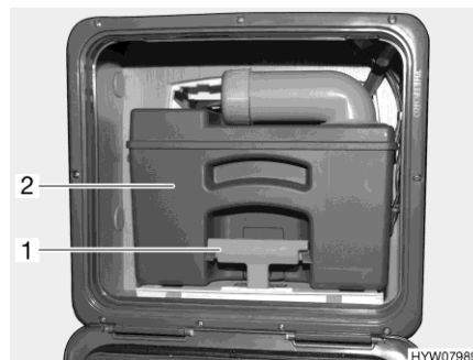
Fig. 300 Depósito de aguas fecales (ejemplo)
