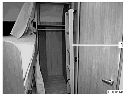
Fig. 14 Escalera de ascenso en el armario ropero
