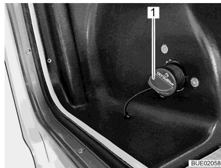
Fig. 43 Tubo de llenado para AdBlue®
