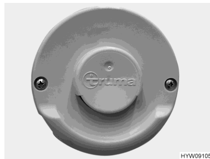
Fig. 232 Tubo de chimenea en la pared (calefacción de aire caliente)
