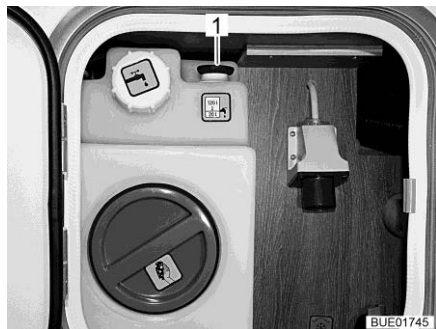
Fig. 275 Depósito de agua (unidad de servicio)
