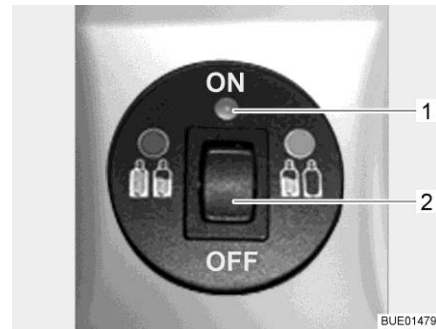
Fig. 180 Unidad de mando con indicación a distancia
