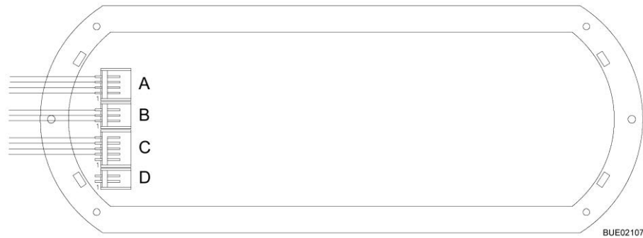
Fig. 214 Schéma de connexions, panneau de contrôle (LT 633)
