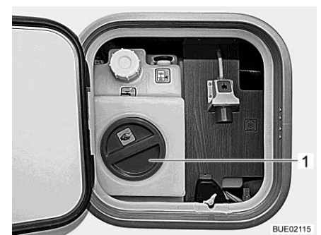
Fig. 303 Ouverture de nettoyage du réservoir d'eau (unité de service)
