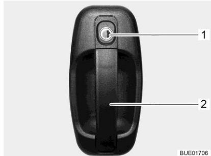
Fig. 52 Serrure de la porte (porte cellule à l'extérieur)
