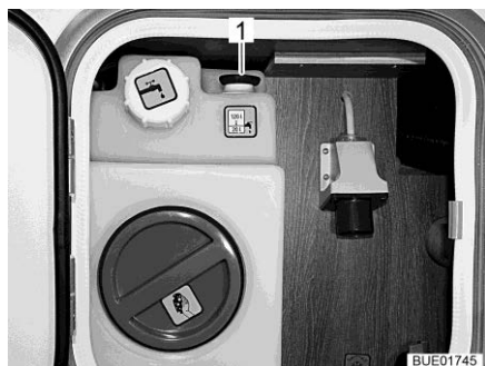
Fig. 275 Réservoir d'eau (unité de service)
