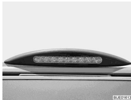
Fig. 73 Eclairage de l'auvent
