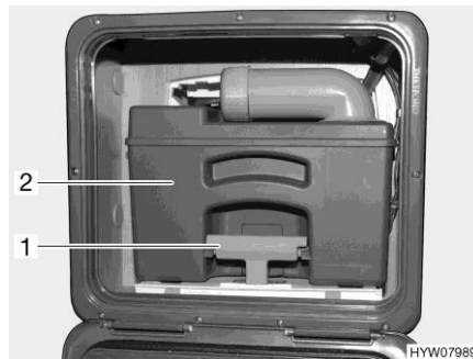
Fig. 278 Serbatoio fecale (esempio)
