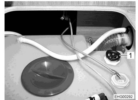
Fig. 256 Serbatoio dell'acqua (alternativa)
