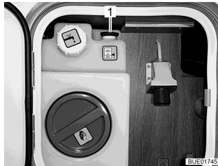
Fig. 255 Serbatoio dell'acqua (unità di servizio)
