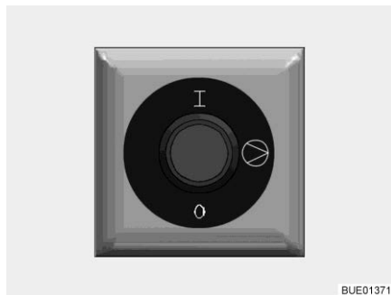
Fig. 219 Interruttore di comando pompa di circolazione aggiuntiva
