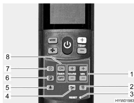
Bild 227 Fjärrstyrning med inställningsknappar (klimatanläggning)
