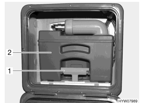
Billede 278 Toilettank (eksempel)
