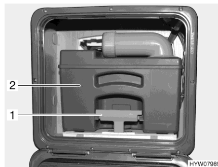
Billede 290 Toilettank (eksempel)
