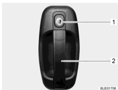
Billede 50 Dørlås (indgangsdør udvendigt)
