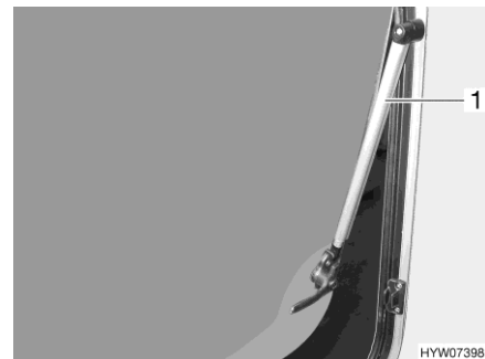
Billede 92 Ventilationsrude med automatiske udskydere
