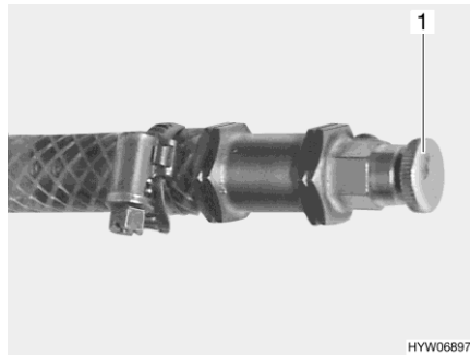
Billede 293 Udluftningsventil varmtvandsvarmeovn
