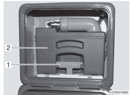
Fig. 175 Serbatoio fecale (esempio)
