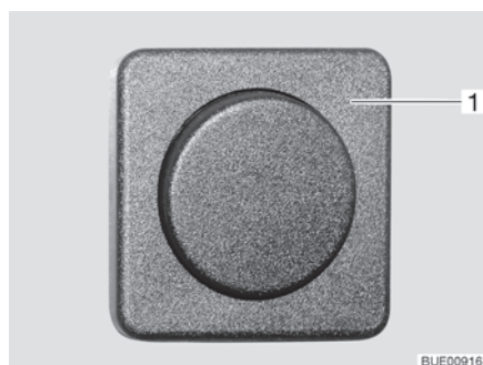
Fig. 60 Interruttore, separato dalla lampada (esempio)
