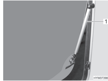
Fig. 70 Finestra apribile con deflettore automatico
