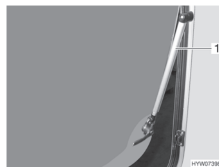
Billede 70 Ventilationsrude med automatiske udskydere
