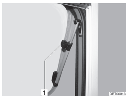
Billede 69 Ventilationsrude med drejeudskyder
